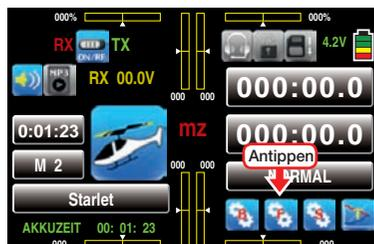
Das Display wechselt zur Anzeige des „blauen“ Funktionsmenüs. Tippen Sie hier mit einem Finger oder dem mitgelieferten Stift auf den Menüpunkt »PIT >> HECK«:
