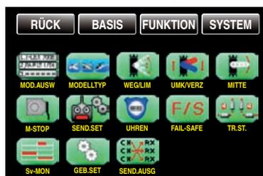
... wobei hinzuzufügen ist, dass das „blaue“, ab Seite 110 bzw. 184 beschriebene, **Funktionsmenü** modelltypspezifische Untermenüs enthält. Die erste der beiden nachfolgenden Abbildungen zeigt deshalb beispielhaft die Menüstruktur eines Flächenmodells und die zweite die eines Helikoptermodells ...
