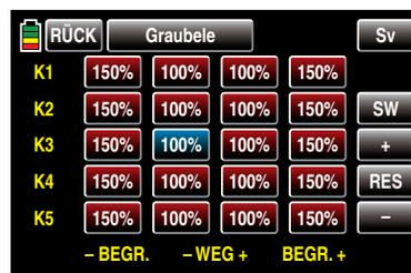
Entsprechend häufiges Antippen der **+**-Taste am rechten Displayrand erhöht den aktuellen Wert und Antippen der **-**-Taste darunter reduziert den Wert im aktiven Werte-Feld. Antippen der **RES**-Taste setzt einen veränderten Wert wieder auf den Standardwert zurück.
