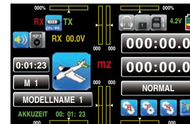
Das blaue Schaltersymbol links oben zwischen dem roten „RX“ und dem grünen „TX“ bedeutet, dass die HF-Abstrahlung des Senders eingeschaltet ist.
