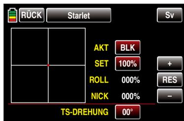
... eines Steuerknüppels bis maximal auf einen kreisförmigen Bereich eingrenzt ... sofern der Limiter in der Zeile „AKT“ **EIN**-geschaltet ist:
