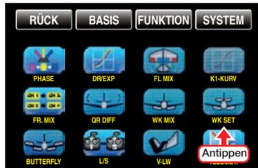
Abhängig von der gewählten Anzahl Querruder und Wölbklappen zeigt das Display unterschiedliche Ansichten. Die obere der beiden folgenden Abbildungen zeigt das Display bei Einstellung von minimal „2QR ...“ und die untere Abbildung bei Wahl von maximal „... 4WK“:
