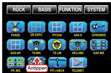
In den Grundeinstellungen haben Sie im Display „Taumelscheibe“ festgelegt, wie viele Servos für die Pitch-Steuerung in Ihrem Helikopter zuständig sind. Mit dieser Festlegung werden automatisch die jeweils nötigen Mischer für die Taumelscheibenfunktionen „Rollen“, „Nicken“ und „Pitch“ aktiviert, sodass Sie selbst keine weiteren Mischer definieren müssen.
