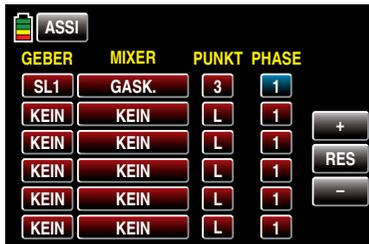
Die aktuelle Phasennummer im nun blauen und somit aktiven Wertefeld verändern Sie anschließend durch entsprechend häufiges Antippen der am rechten Displayrand platzierten Tasten **+** oder **-**, beispielsweise:
