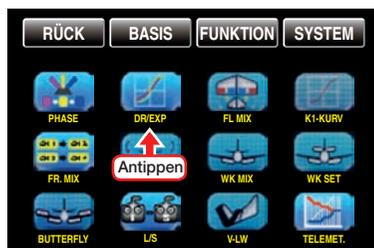
Die Dual-Rate-/Expo-Funktion ermöglicht eine flugphasenabhängige Umschaltung oder Beeinflussung der Steuerausschläge und -charakteristiken für Quer- (QR), Höhen- (HR) und Seitenruder (SR), d.h. der Steuerfunktionen 2 ... 4 über Schalter.
