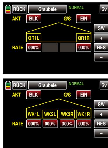
In diesem Menü ist eine besondere Klappenkonstellation, „Krähenstellung“ oder „Butterfly“ genannt, einstellbar: Bei dieser Bremsstellung bewegen sich beide Querruder gemäßigt nach oben und die Wölbklappen so weit wie möglich nach unten. Über einen dritten Mischer wird ggf. das Höhenruder so nachgetrimmt, dass sich die Fluggeschwindigkeit dennoch nicht wesentlich gegenüber der Normalflugposition ändert.
