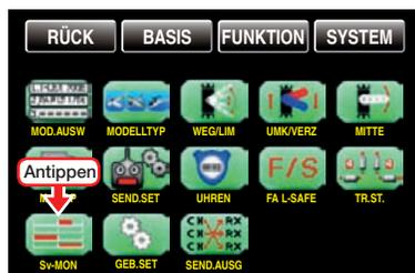
Die optische Anzeige der aktuellen Servopositionen kann jedoch nicht nur durch die vorstehend beschriebene Anwahl dieses Menüpunktes aufgerufen werden, sondern bei inaktiven Wertefeldern alternativ auch aus der Grundanzeige und beinahe allen Menüpositionen durch gleichzeitiges Drücken der links vom Display befindlichen Tasten ▲ ▼. Anschließendes Drücken der darunter befindlichen ESC-Taste bringt Sie wieder direkt an den Ausgangspunkt zurück.
