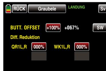
Bewegen Sie anschließend das dem Eingang „K1“ zugewiesene Bedienelement, standardmäßig den Gas-/Brems-Steuerknüppel, in die Position, bei der die Klappen eingefahren oder geschlossen sein sollen. Die jeweils aktuelle Geberposition wird rechts des Wertefeldes in gelber oder weißer Farbe dargestellt.
