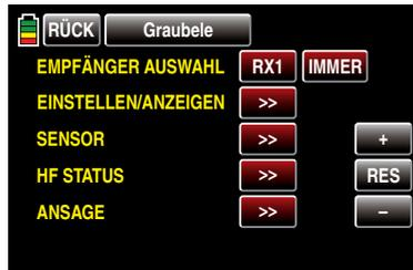
Mit dieser Firmwareversion wurde in der Zeile „EMPFÄNGER AUSWAHL“ eine Auswahl Taste hinzugefügt sowie infolgedessen am rechten Displayrand drei Einstelltasten.
