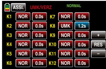
Antippen der **RES**-Taste darunter reduziert einen Wert auf minimal 0,0s und Antippen der **RES**-Taste setzt einen veränderten Wert auf den Standardwert zurück.
