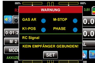
Antippen der Taste **SET** öffnet direkt das Untermenü »Send.SET« des Basismenüs, in dessen Zeile „Bind EIN/AUS“ Sie ggf. Ihren Empfänger binden ...
