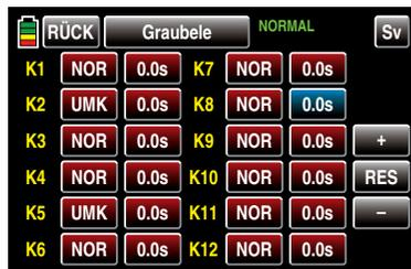
Entsprechend häufiges Antippen der **+**-Taste am rechten Displayrand erhöht den Wert bis auf max. 9,9s, beispielsweise:
