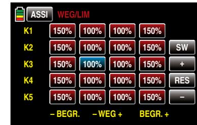
Entsprechend häufiges Antippen der **+**-Taste am rechten Displayrand erhöht den Wert des aktiven Optionsfeldes. Antippen der **RES**-Taste darunter reduziert den aktuellen Wert des aktiven Feldes und Antippen der **RES**-Taste setzt einen veränderten Wert wieder auf den Standardwert zurück.
