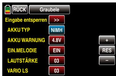
Durch Antippen der Tasten **+** oder **-** am rechten Displayrand wählen Sie nun den passenden Akkutyp aus, z. B.:
