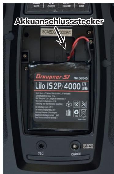
Dann den Stecker des Senderakkus durch vorsichtiges Ziehen am Zuleitungskabel lösen. Anschließend den Akku anheben und ohne Kraftanwendung vom Klettband abziehen.
