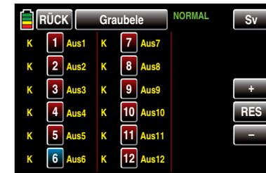
Wählen Sie nun durch entsprechend häufiges Antippen der **+** oder **-**-Taste mit einem Finger oder dem mitgelieferten Stift den gewünschten Eingangskanal respektive Senderausgang, siehe Seite 106, aus, z. B.:
