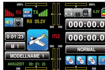
Bei Unterschreiten einer im Display „RX SERVO TEST“ des Untermenüs „EINSTELLEN, ANZEIGEN“ des »Telemetrie«-Menüs, ab Seite 135, einstellbaren Warnschwelle – standardmäßig 3,8V – erfolgt eine optische und akustische Unterspannungswarnung.
