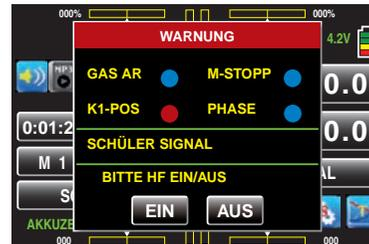
Mit einem Antippen der Taste **EIN** mit einem Finger oder dem mitgelieferten Stift setzen Sie den LS-Betrieb fort. Antippen von **AUS** beendet den Schulungsbetrieb.
