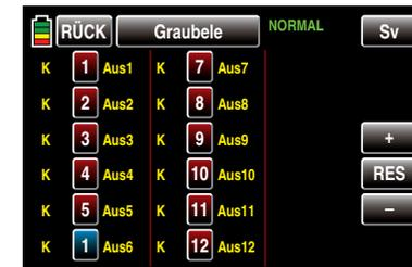
Antippen der Taste **RES** setzt einen geänderten Ausgang auf die Standardzuordnung zurück.
