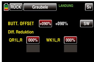
Nachdem nun der zur richtigen Beurteilung der einzustellenden Klappenausschläge nicht ganz unwichtige Brems-Offset gesetzt ist, kehren Sie zur ersten Displayseite des Menüs »BUTTERFLY« zurück, indem Sie die Taste **SW** [Seitenwechsel] am rechten Displayrand mit einem Finger oder dem mitgelieferten Stift einmal antippen:
