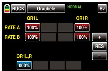
Anschließend können Sie im aktiven, d.h. blau dargestellten, Wertefeld mit der **+**-Taste den aktuellen Wert erhöhen und mit der **-**-Taste reduzieren, z.B.:
