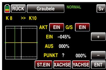
Der Schnittpunkt der grünen Linie mit der jeweiligen Mischerkennlinie ist als „AUS(gang)“ bezeichnet und kann an den Stützpunkten im Bereich von  $\pm 125\%$  variiert werden, siehe weiter unten. Das resultierende Steuersignal wirkt auf den Mischerausgang.
