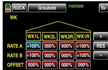
Anschließend können Sie im aktiven, d. h. blau dargestellten, Wertefeld mit der **+**-Taste den aktuellen Wert im Bereich von  $\pm 125\%$  erhöhen und mit der **-**-Taste reduzieren, z. B.:
