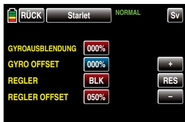
Basierend auf diesen flugphasenspezifisch festgelegten (Offset-) Einstellungen kann die Gyrowirkung mit einem in der Zeile „Gyro“ im Menü »Geberzuweisung«, Seite 100, zugewiesenen Geber zusätzlich stufenlos variiert werden.
