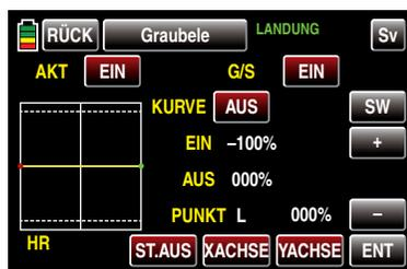
Schalten Sie die Anzeige der Geberposition durch Antippen der Taste **ST.AUS** links unten im Display mit einem Finger oder dem mitgelieferten Stift ein, damit Sie die nötigen Einstellungen vornehmen können:
