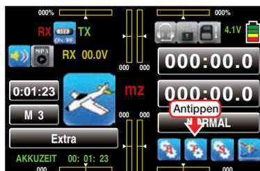
Das Display wechselt zur Anzeige des „blauen“ Funktionsmenüs. Tippen Sie hier mit einem Finger oder dem mitgelieferten Stift auf den Menüpunkt »L/S«:
