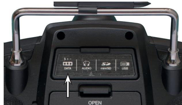
Diese ist für den Anschluss der optional erhältlichen Smart-Box (Best.-Nr. **33700**) oder alternativ eines externen Bluetooth-Moduls (Best.-Nr. **S8351**) vorgesehen.
