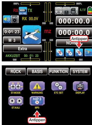
... sondern auch direkt, durch Antippen des in der Grundanzeige des Senders befindlichen MP3-Icons, erfolgen:
