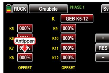
Die Farbe des Wertefeldes wechselt von rot nach blau. Stellen Sie nun mit der **+**- bzw. **-**-Taste rechts außen den gewünschten Wert ein, beispielsweise:
