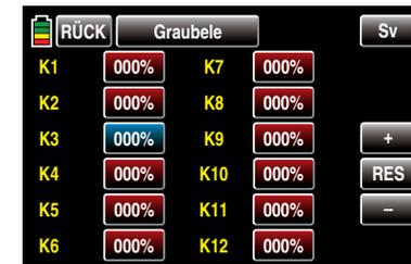
Durch entsprechend häufiges Antippen der **+**- oder **-**-Taste rechts außen verändern Sie den Wert, beispielsweise:
