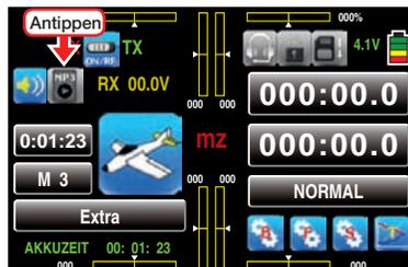
Des Weiteren kann das-geöffnete-MP3-Menü alternativ auch mit den beidseits des Displays befindlichen Tasten bedient werden:
