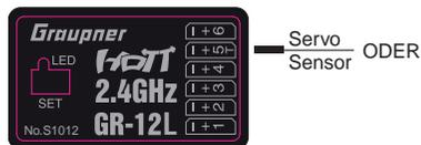
... alternativ nicht nur das Adapterkabel mit der Best.-Nr. **7168.6S** zum Updaten des Empfängers sondern auch ein Telemetrie-Sensor angeschlossen werden. Damit das jeweils angeschlossene Gerät jedoch vom
