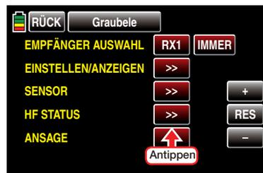
... öffnet sich das ausgewählte Untermenü. Dieses visualisiert die Qualität der Verbindung von Sender und Empfänger:
