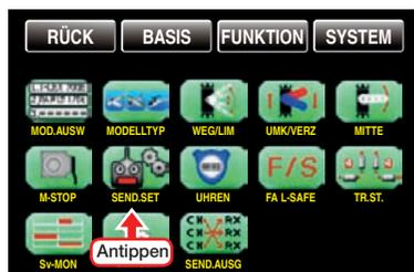
Dieses Menü bietet Ihnen die Möglichkeit, senderspezifische Funktionen wie z. B. „Binden“, „Senderausgänge“, „HF AN/AUS“, „HF-Typ“, „Reichweitentest“ und „DSC-Ausgang“ zu konfigurieren:
