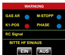
Parallel dazu wird solange das automatische Einschalten des HF-Moduls unterdrückt, bis sich durch Zurücknehmen des Gaslimiters oder des Gas-/Pitch-Steuerknüppels das Ausgangssignal des Kanals 6 im Leerlaufbereich befindet.
