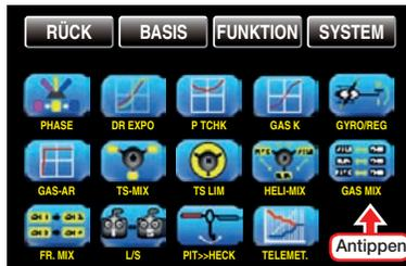
Nicht nur eine Pitchvergrößerung erfordert eine entsprechende Gasmitnahme, sondern auch große zyklische Steuerbewegungen, d.h. das Kippen der Taumelscheibe in eine beliebige Richtung. Aber auch eine Erhöhung des Heckrotorschubes erfordert eine entsprechende Anpassung der Motorleistung, um die Systemdrehzahl konstant zu halten. In den Programmen der Sender **mz-18** HoTT und **mz-24** HoTT kann die Gasmitnahme für die Roll-, Nick- und Heck-Steuerung getrennt angepasst werden.
