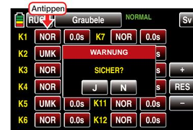
Antippen von **N** mit einem Finger oder dem mitgelieferten Stift bricht den Vorgang ab. Antippen von **J** bestätigt den Vorgang und kehrt die Laufrichtung des an K1 bzw. K6 angeschlossenen Servos um.
