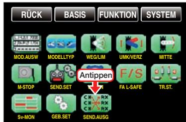
Um maximale Flexibilität hinsichtlich der Empfängerbelegung zu erreichen, ist im Programm der Sender **mz-18** HoTT und **mz-24** HoTT die Möglichkeit zum beliebigen Vertauschen der Senderausgänge 1 bis maximal 9 oder 12 integriert:
