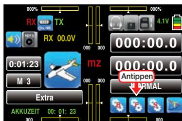
Das Display wechselt zur Anzeige des „blauen“ Funktionsmenüs. Tippen Sie hier mit einem Finger oder dem mitgelieferten Stift auf den Menüpunkt »**SNAP ROLL**«:
