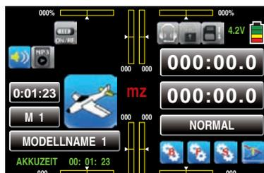
Wird in obigem Display beispielsweise das mit „M 1“ beschriftete Feld „Modellspeicher“ mit einem Finger oder dem mitgelieferten Stift angetippt, öffnet sich das Auswahlm Menü „Modellspeicher“:
