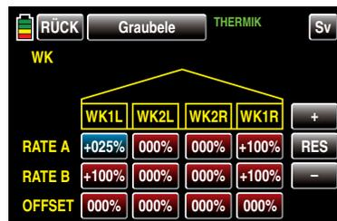
Mit dem Wert des Ausschlags der linken Wölbklappe nach unten (RATE B) wie auch der Werte der rechten Wölbklappe sowie eines ggf. vorhandenen zweiten Wölbklappenpaares verfahren Sie gleichartig. Symmetrische und asymmetrische Werte sind möglich.
