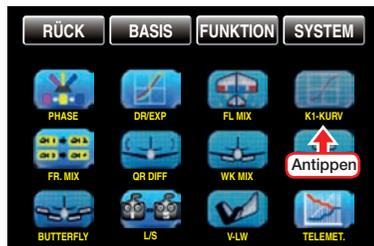
In diesem Menü kann nicht nur die Vergaserkennlinie, sondern auch die Leerlauf- oder „Motor aus“-Position des Gasknüppels entsprechend angepasst werden.
