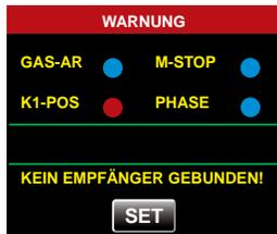
... ist der aktuell aktive Modellspeicher derzeit an keinen Empfänger „gebunden“. Durch Antippen der Taste **SET** gelangen Sie unmittelbar in das Menü »Sendereinstellung«, ...
