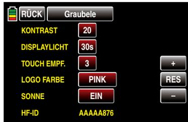
Diese ist senderspezifisch, wird je Sender nur einmal vergeben und kann nicht verändert werden. Während des HoTT-Synchronisationsvorganges wird u. a. diese ID an den Empfänger übertragen, sodass dieser jederzeit in der Lage ist, die Funksignale „seines“ Senders zu identifizieren.
