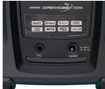
Die Ladebuchse ist serienmäßig über eine Schutzdiode gegen Verpolung geschützt. Original *Graupner*-Automatikladegeräte erkennen dennoch die Spannungslage des Akkus. Beachten Sie die Einstellhinweise des verwendeten Ladegerätes.
