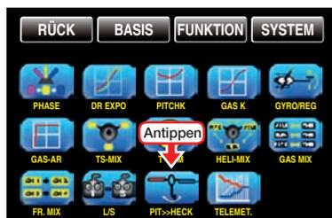
Standardmäßig ist eine Drehmomentausgleichskurve mit einem linearen Mischanteil von einheitlich 0 % vorgegeben, wie sie für einen im „Heading-Lock-Modus“ arbeitenden Gyrosensor erforderlich ist:
