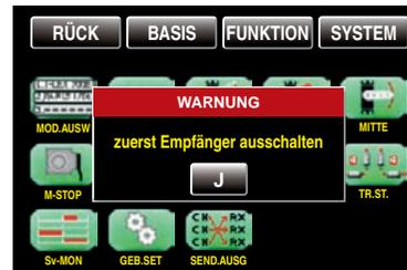
..., dann besteht noch eine Verbindung zwischen Empfänger und Sender. Schalten Sie also Ihren Empfänger aus und probieren Sie es noch einmal:
