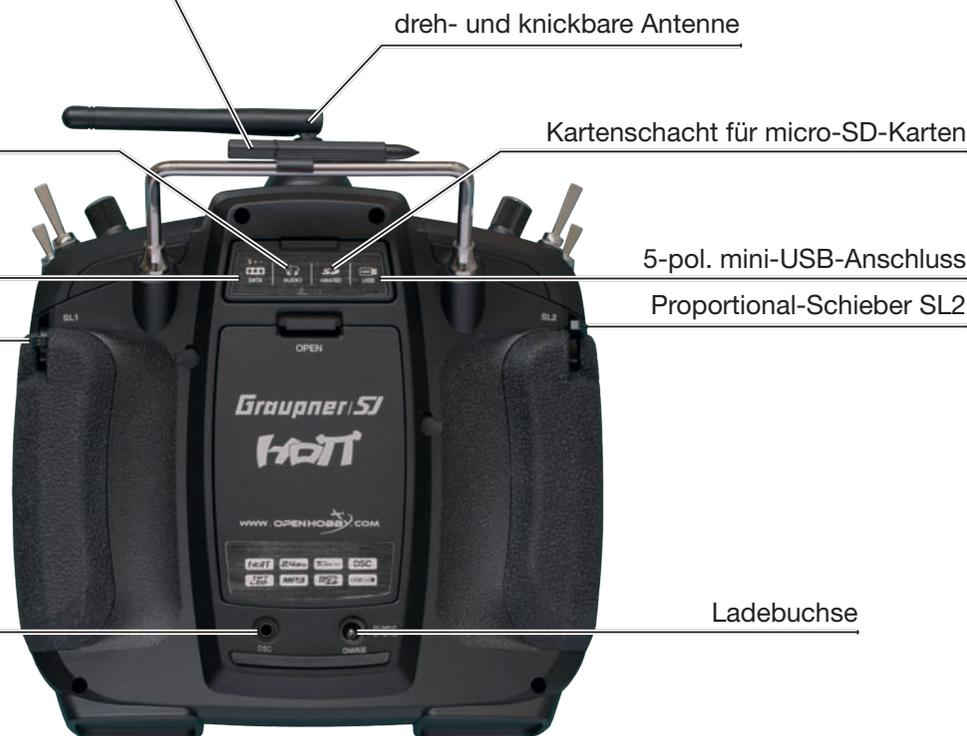
dreh- und knickbare Antenne
