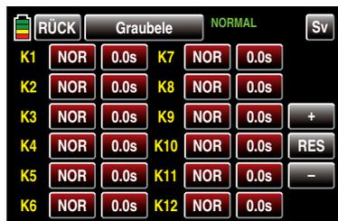
In diesem Display wird in der-jeweils linken-Spalte ausschließlich die das jeweilige Servo betreffende Drehrichtung eingestellt. Beginnen Sie bei der Einstellung von Servos grundsätzlich mit der ggf. nötigen Drehrichtungsumkehr bevor Sie andere Parameter einstellen!
