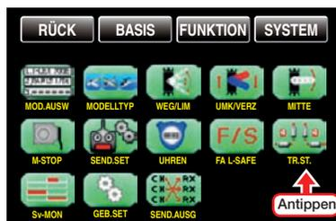
Die beiden Kreuzknüppel sind mit einer digitalen Trimmung ausgestattet. Kurzes Antippen der Trimmgeber verstellt mit jedem „Klick“ die Neutralposition der Kreuzknüppel um einen bestimmten Wert. Bei längerem Festhalten läuft die Trimmung mit zunehmender Geschwindigkeit in die entsprechende Richtung.
