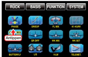
Innerhalb eines Modellspeicherplatzes bieten die Sender **mz-18** HoTT und **mz-24** HoTT die Möglichkeit, bis zu 6 voneinander abweichende Einstellungen für unterschiedliche Flugzustände, üblicherweise als Flugphasen bezeichnet, in den entsprechenden Menüs zu programmieren. Erkennbar sind diese Menüs am rechts oben im Display in grüner Farbe eingeblendeten Flugphasennamen. Standardmäßig ist das der Name der Flugphase 1, welche mit dem Namen „PHASE 1“ oder „NORMAL“ vorbelegt ist.
