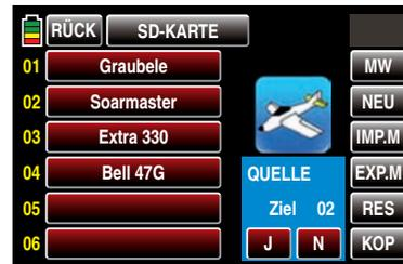
Von der SD-Speicherkarte zu importierendes Modell mit einem Finger oder dem mitgelieferten Stift antippen. Die Farbe des Feldes wechselt von rot nach blau und unten rechts werden weitere Informationen und Tasten eingeblendet.
