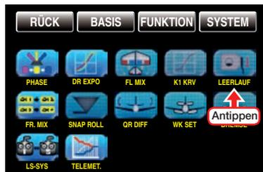
Üblicherweise wird der Leerlauf eines Verbrennungsmotors mit dem digitalen Trimm-Geber des Gas-Steuernüppels eingestellt. Diese von der jeweiligen Position des Trimm-Gebers abhängige Leerlaufposition des Gasservos kann bei Bedarf mit einem in diesem Menü im Bereich von  $\pm 20\%$  beliebig einstellbaren Wert per Schalter in Richtung höheren oder niedrigeren Leerlauf verschoben werden.
