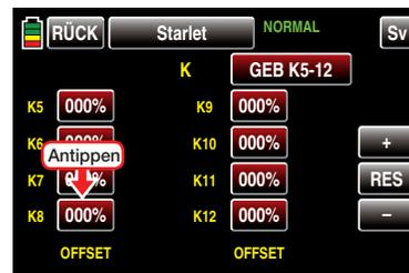
Die Farbe des Wertefeldes wechselt von rot nach blau. Stellen Sie nun mit der **+**- oder **-**-Taste rechts außen den gewünschten Wert ein, beispielsweise:
